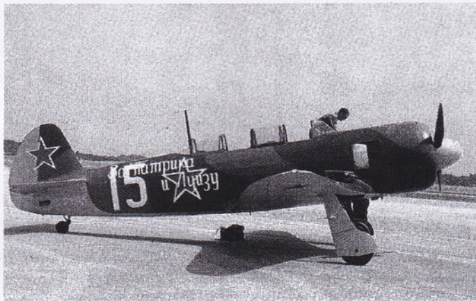
Fehlzündungen: Ein Mechaniker versucht, die notgelandete Jak-11 zu reparieren. Der Kondensator war durchgeschmort. FOTO: SG-ETUO.DE
